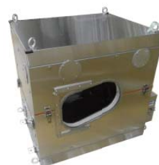
供試体用恒温槽 駆動部品温度 -50℃仕様
