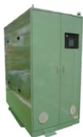
コールドスタート試験用ATF温調装置 プラインレス直影方式の低コスト仕様
